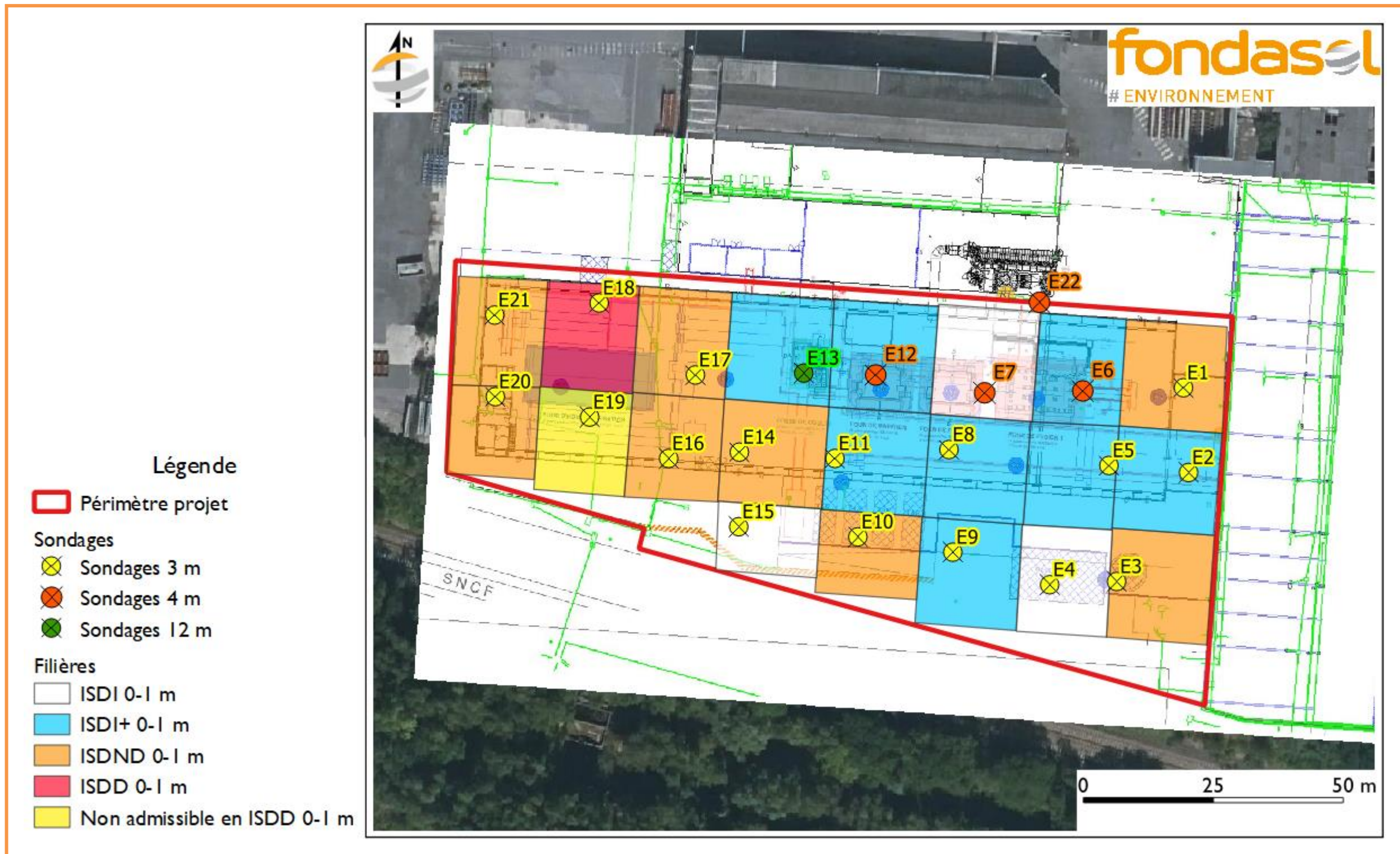
Figure 7 : Synthèse cartographique des résultats d'analyses sur les terres à excaver entre 0-1 m
