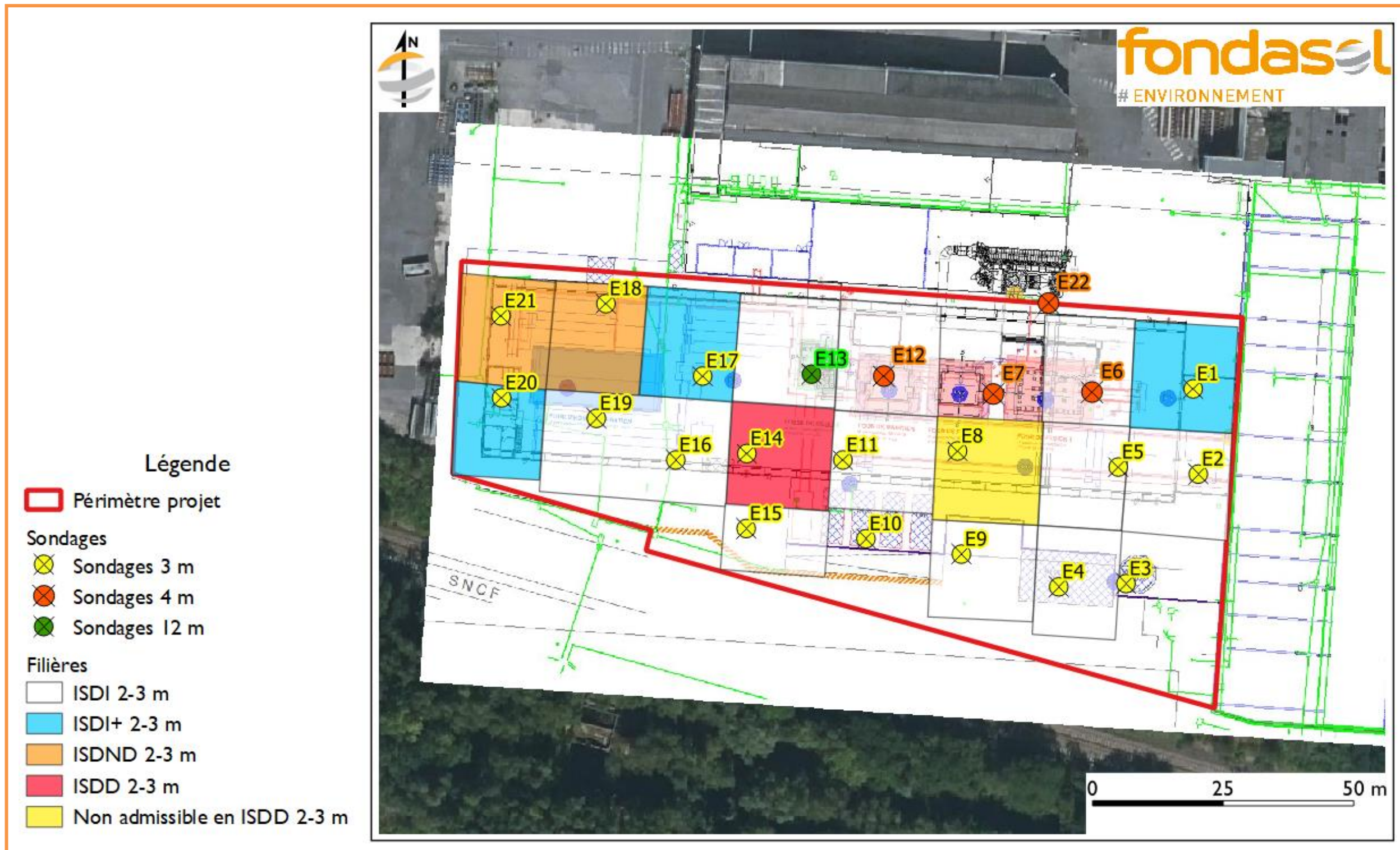
Figure 9 : Synthèse cartographique des résultats d'analyses sur les terres à excaver entre 2-3 m
